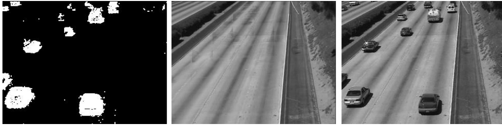
شکل ۴-۱: یک فریم از یک ویدیوی نمونه و زمینه استخراج شده بر اساس روش مورد استفاده و نتیجه شناسایی اشیاء متحرک مبتنی بر زمینه بدست آمده.
