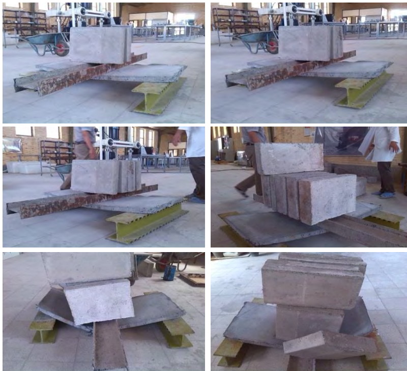
شکل ۲: آزمایش بارگذاری بر روی نمونه فروسیمانی معمولی
