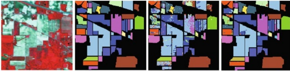
شکل ۱-۲: (آ) تصویر اصلی ، (ب) تصویر مرجع ، (پ) خروجی قطعه‌بندی با روش SVM و (ت) خروجی قطعه‌بندی با روش SDL
