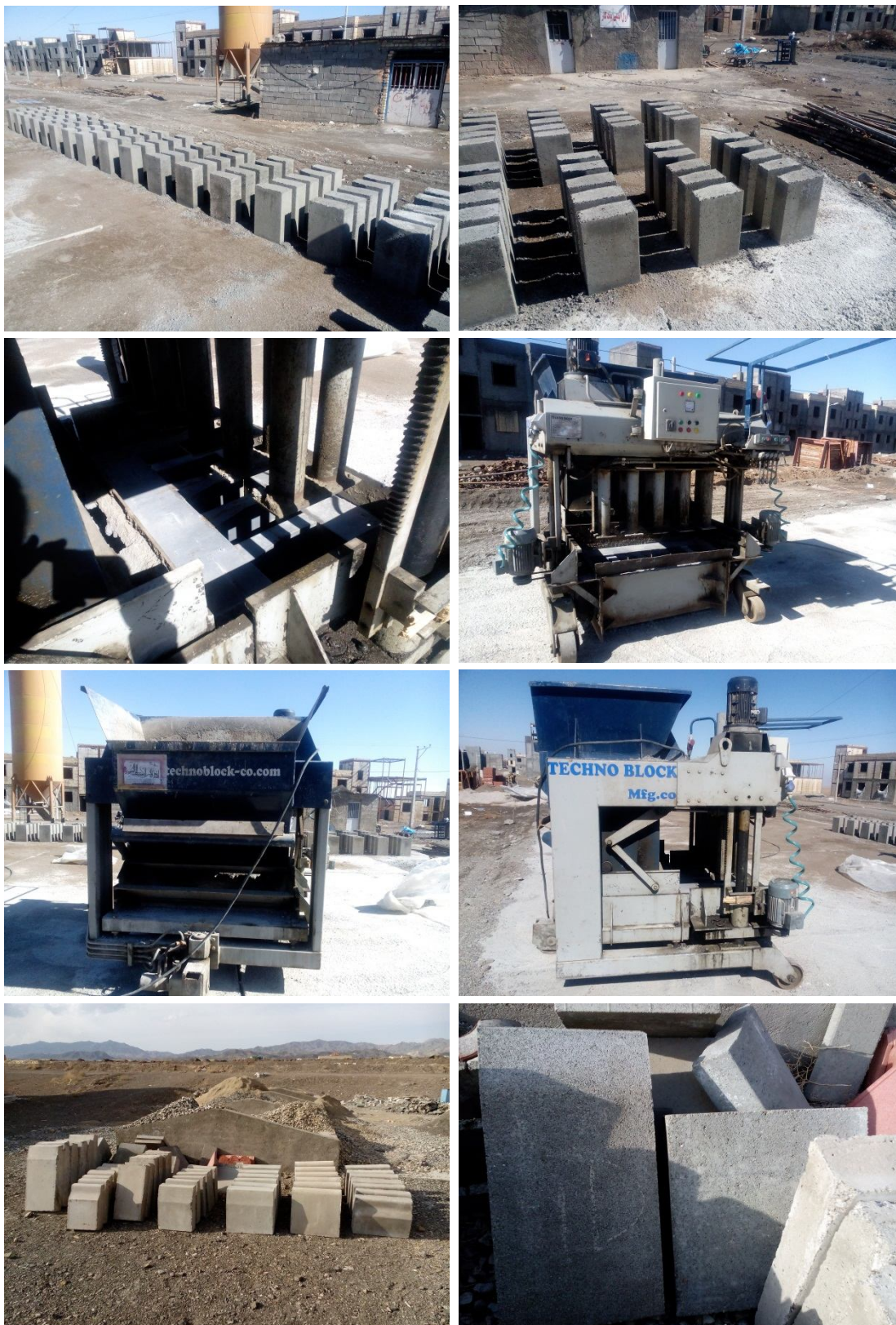
شکل ۱: دستگاه تولید جدول پرسی خشک و نمونه جدول
